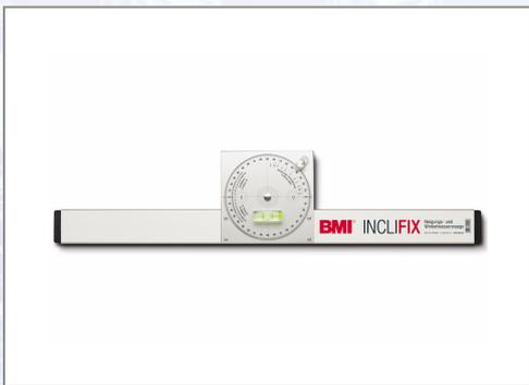
Aufgebaut auf ein eloxiertes Wasserwaagenprofil. Drehbarer Libellenträger mit %- und Grad-Skala zum Übertragen von Neigungen. Länge 60 cm. 3 verschiedene Messwerte sind ablesbar. Winkelgrade von  $4 \times 90^\circ = 360^\circ$ , Skalen von Gefällen in Prozent von 0 – 100 %, Skala für Böschungs- und Neigungsverhältnisse.
