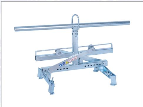
Verlegezange für Rasengittersteine, universell einsetzbar durch austauschbare Adapter. Serienmäßig ausgerüstet: - Wechsellautomatik, vollautomatische Umschaltung von Greifen auf Lösen, - Einhängeöse für Kranhaken, - Anschraubmöglichkeit für Adapter. Technische Daten: - Greifbereich: 300 - 500 mm, - Tragfähigkeit: 250 kg, - Gewicht: 20,0 kg.
