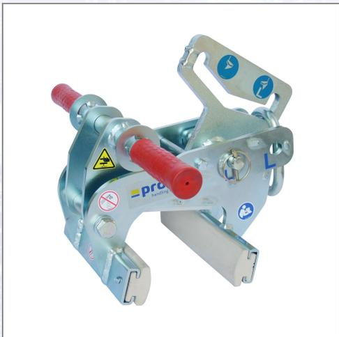
Serienmäßig ausgerüstet: - Umsteckmöglichkeit um Schwerpunktlagen des Greifguts auszugleichen, - Umschalten von Greifen und Lösen über die Aufhängung, - graue austauschbare Profilmummileiste. Technische Daten: - Greifbereich: 116 - 120 mm, - Eintauchtiefe: 95 mm, - Backenlänge: 235 mm, - Tragfähigkeit: 600 kg, - Gewicht: 14,0 kg.
