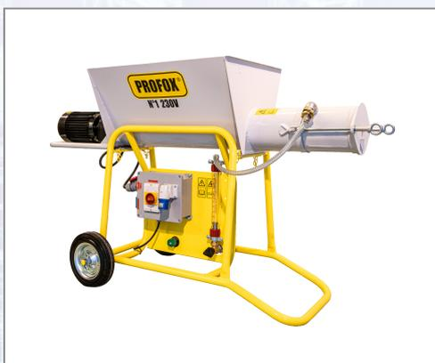
Der Durchlaufmischer mit kompaktem Mischtopf ist speziell geeignet für die Verarbeitung von Mörtel, WDVS-Kleber, Zementstrich und Putzen mit Körnung bis 8 mm. Technische Daten: - Anschluss: 230 V / 50 Hz, - Wasserdruck: min. 3 bar, - Mischleistung: 25-35 l/min, - Direktantrieb über Getriebemotor: 2,2 kW, - Abnehmbarer Materialbehälter, - Durchflussmesser: 100-1000 l/h. Lieferumfang: Mischrohr mit kompaktem Mischtopf, abnehmbares Gestell.
