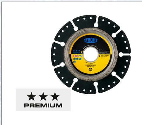
Die Trenn- und Anfassscheibe DCCI COMBI wurde zum Bearbeiten von Kunststoffrohren entwickelt. Der galvanisierte Schneiderand und der diamantbeschichtete Anfaser ermöglichen ein konstantes und sauberes Schneiden bei gleichzeitigem Anfassen. Als zusätzliche Hilfe dient der Schnitttiefenanschlag.
